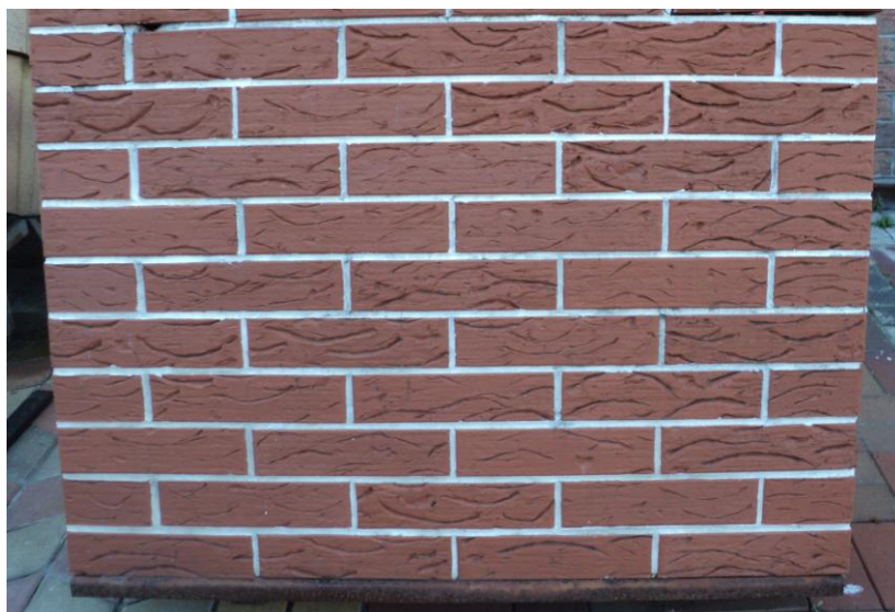
Рис. 5.39. Дослідно - промислова панель із використанням розчину на білому цементі
