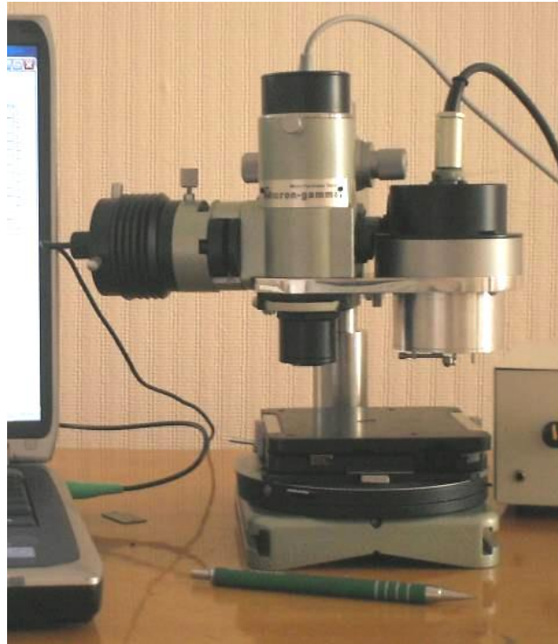
Рисунок 2.8 – Прилад “Micron-gamma” для дослідження фізико-механічних властивостей методами індентування
