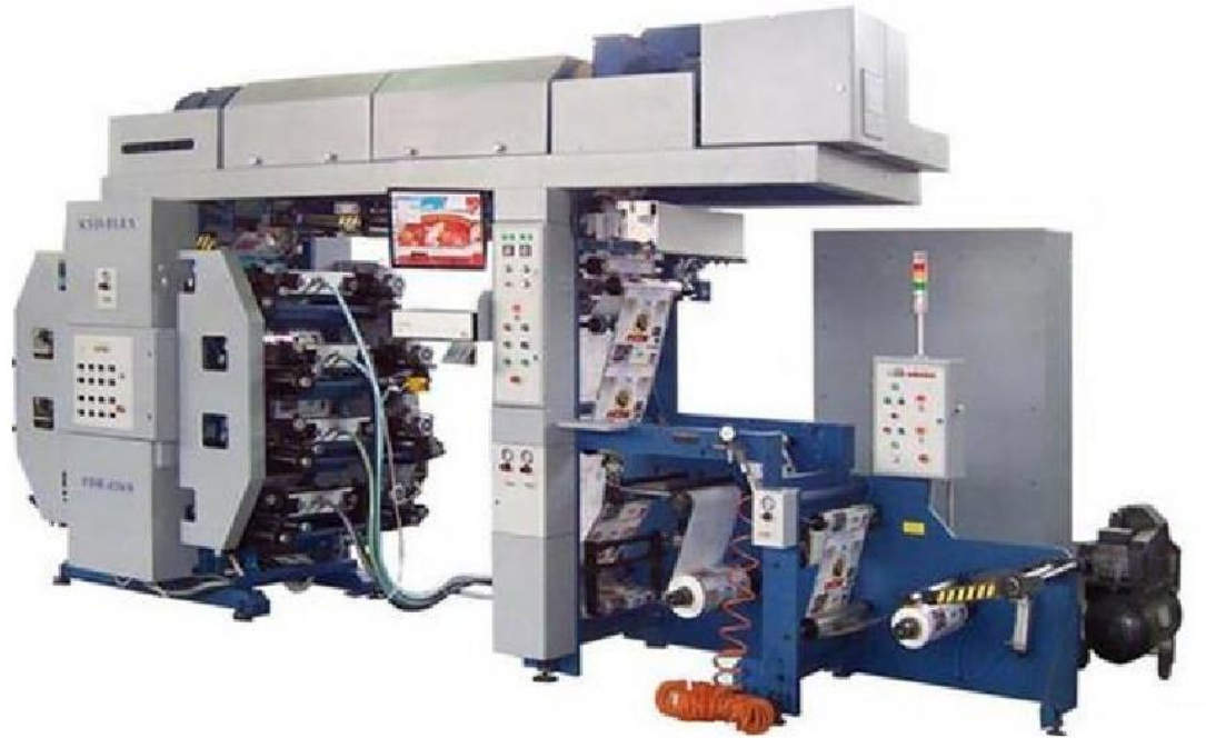
Рис. 2.15 - 8-фарбова планетарна вузькорулонна флексографічна машина ФДР- 420/8 із центральним друкованим циліндром
