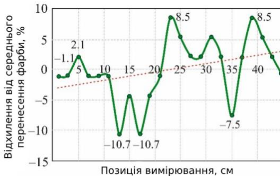
Рис. 3.17 - Зміна перенесення фарби анілоксовим валом уздовж осі.
