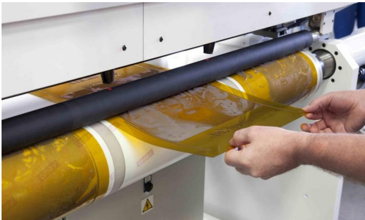
Рис. 1.4 - Друкарська форма флексографічного друку
