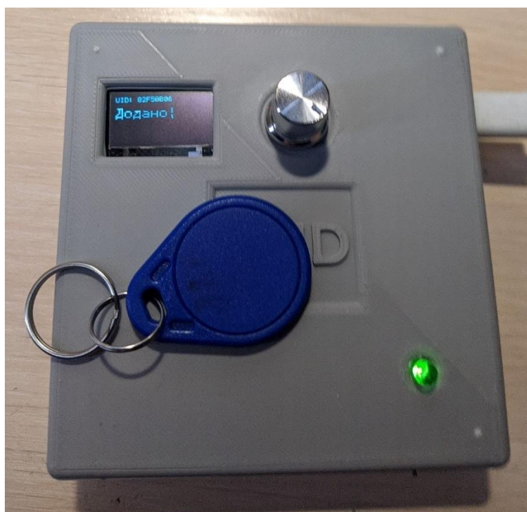
Рисунок 4.19 – Результат додавання RFID-мітки до БД
