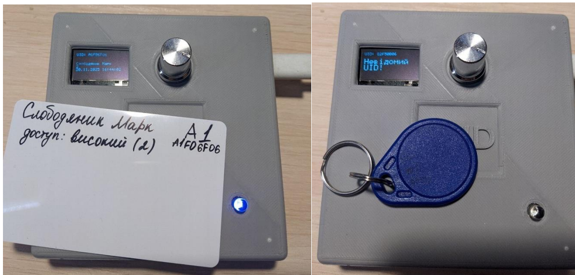
Рисунок 4.18 – Результат розпізнавання RFID-міток
