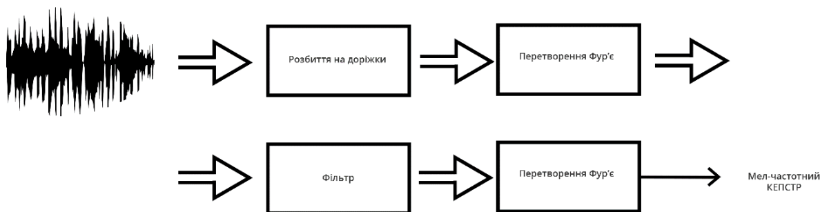
Рисунок 2.3 – Схематичне відображення алгоритму вилучення ознак MFCC
