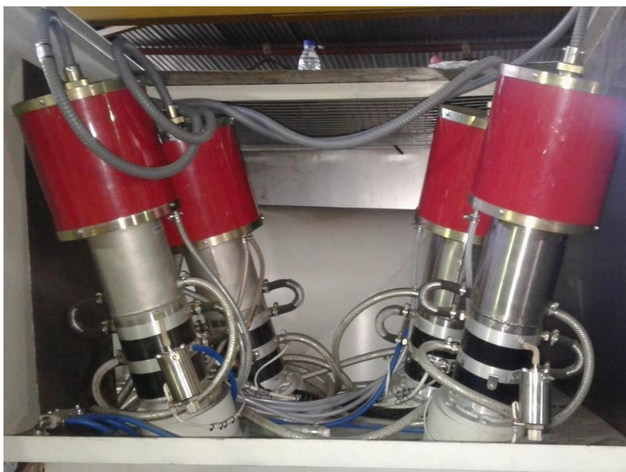
Рис. 1.5 Газорозрядні електронно-променеві гармати ВТР-100 у складі плавильної установки
