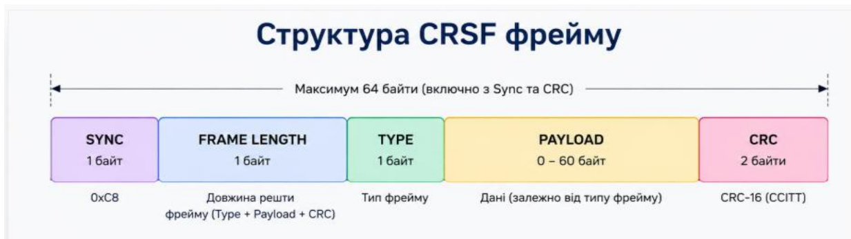
Рисунок 2.1 – Структура CRSF пакету
