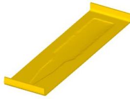
а) Зазор між пуансоном та матрицею 0,1
