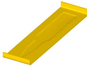
б) зазор між пуансоном та матрицею 0,15
