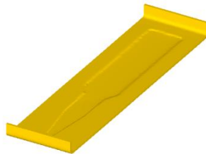
в) Зазор між пуансоном та матрицею -0,1
