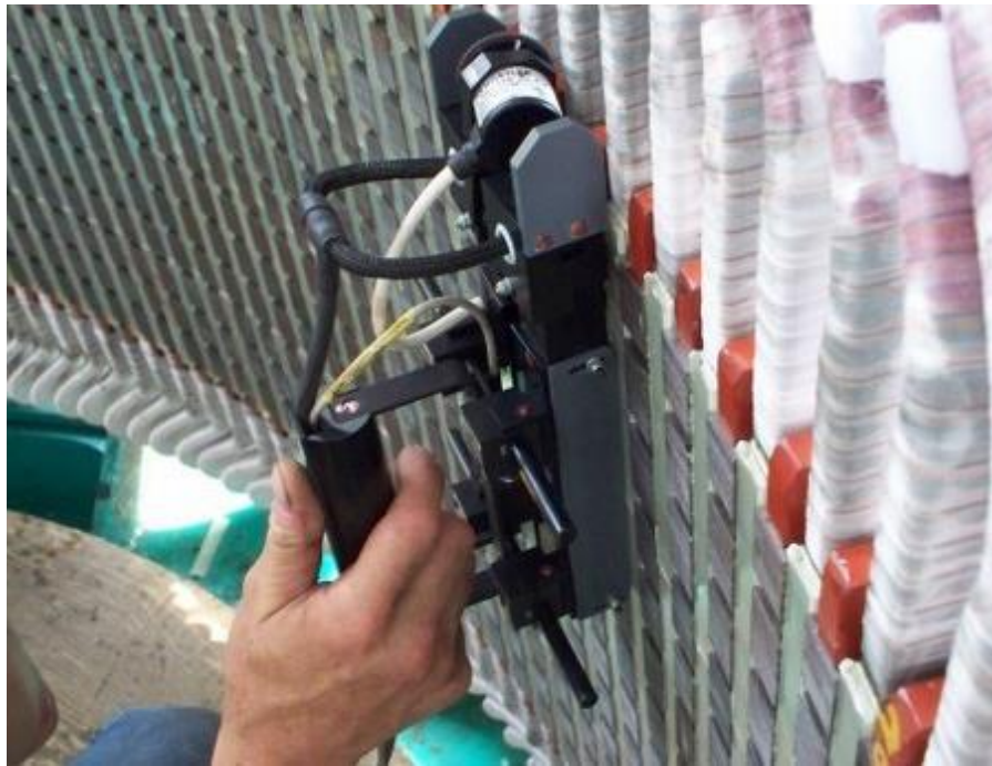
Рисунок 1.3. - Застосування методу електромагнітної детекції дефектів осердя
