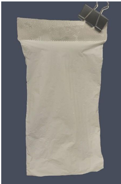
Рисунок 2.12 – Фото полімерної плівки, виготовленої з VT-475, LiTFSI, PYR14-TFSI та LATP
