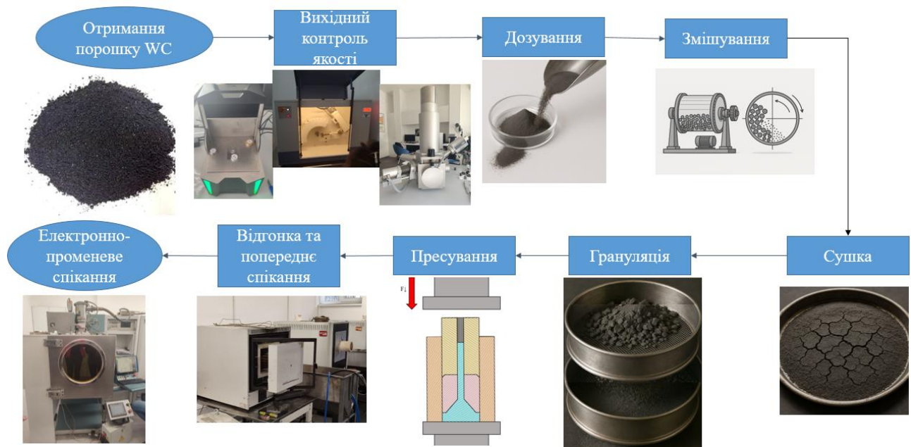
Рисунок 2.1 – Схематичне зображення етапів синтезу та формування філь'єри
