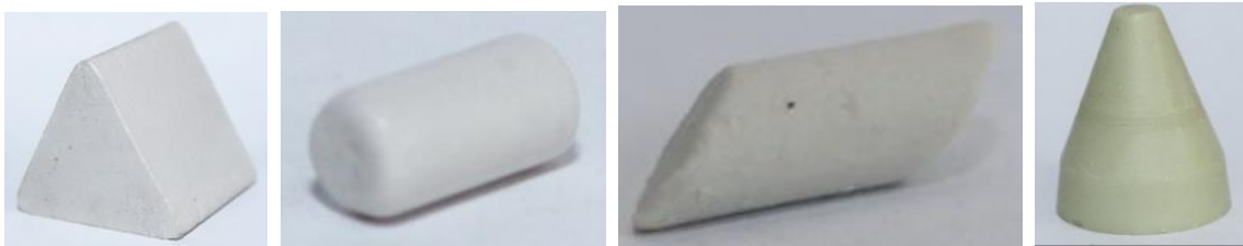
Рис. 7.4. Наповнювач для вібраційної установки: а) призматичний; б) циліндричний; в) похилений; г) пірамідальний
