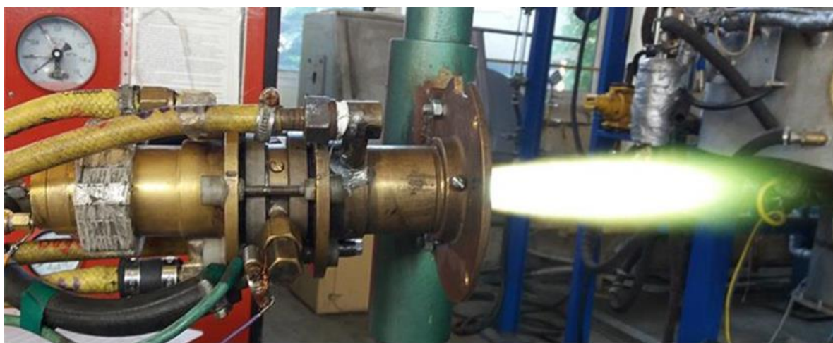
Рис. 12.2. Плазмотрон з водою в якості плазмоторної речовини
