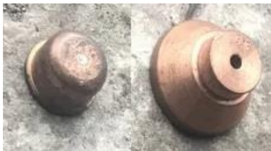
Рис. 12.9. Швидко зношені деталі плазмоторна ВІР-15: а) електрод з цирконієвою або гафнієвою вставкою; б) сопло з отвором діаметром 3,5 мм
