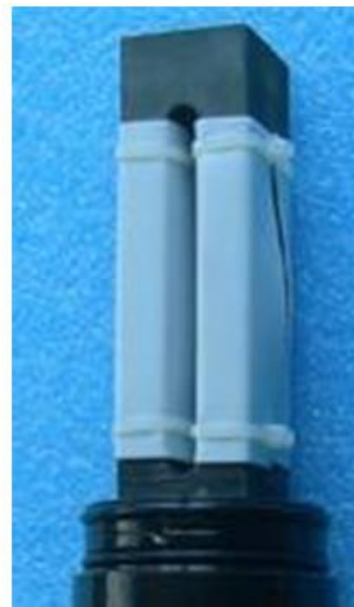
Рис. 6.2. Магнітострикційний перетворювач: а) схема; б) осердя з обмотками
