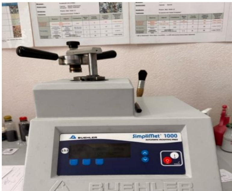
Рисунок 2.4 – Зовнішній вигляд установки «Buehler SimpliMet1000»
