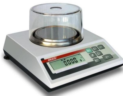
Рисунок 2.2 – Зовнішній вигляд електронних лабораторних вагів «AXISAD50»
