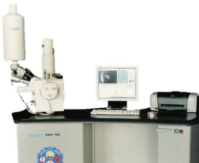
Рисунок 2.7 – Зовнішній вигляд растрового електронного мікроскопа “РЭМ-106И”
