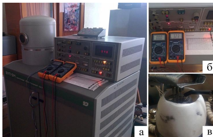
а – ВУП-5М; б – вольтметри; в – чотиризондовий пристрій для визначення електроопору.
