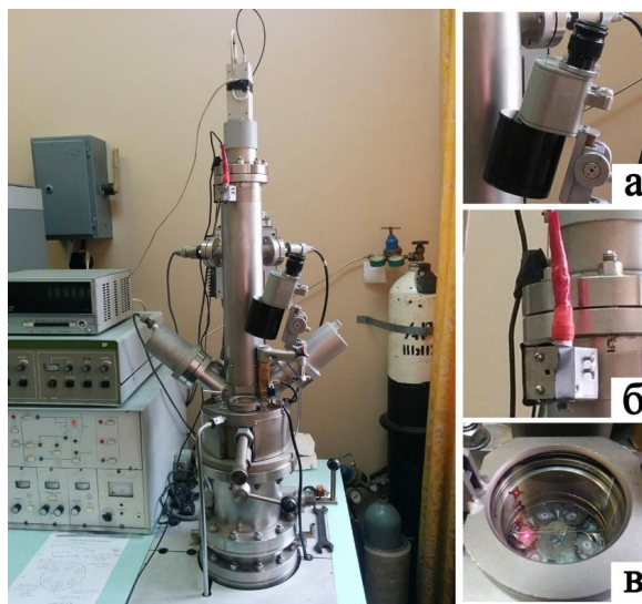
Рисунок 2.24 – Модифікована установка ВІМС з додатковим устаткуванням: оптичний мікроскоп (а), лазерний модуль (б), оптичний столик із застосуванням лазерно-оптичного прицілювання (в) [127]
