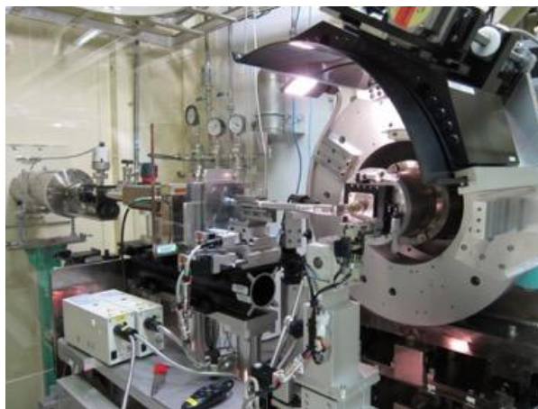
Рисунок 2.19 – Фото камери Дебая-Шеррера, BL44B2.
