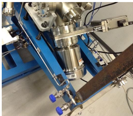
Рисунок 2.11 – Клапан UHV, встановлений перед турбомолекулярним насосом
