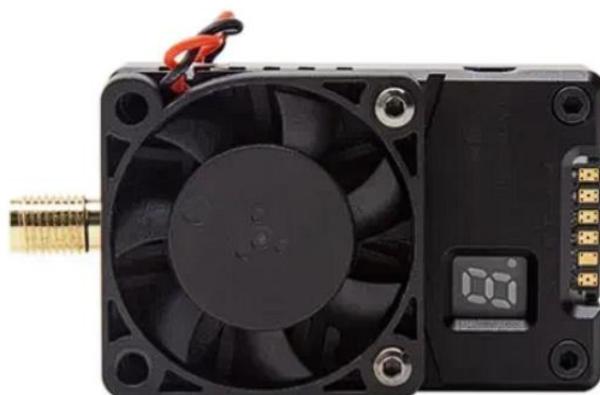
Рисунок 1.3 – Аналоговий відеопередавач Skyzone AtomRC TX2500.
