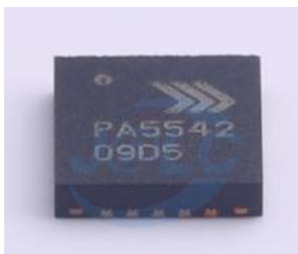
Рисунок 3.11 – Підсилювач потужності RFPA5542TR13
