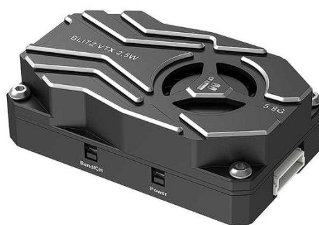
Рисунок 1.2 – Аналоговий відеопередавач iFlight BLITZ Whoop.
