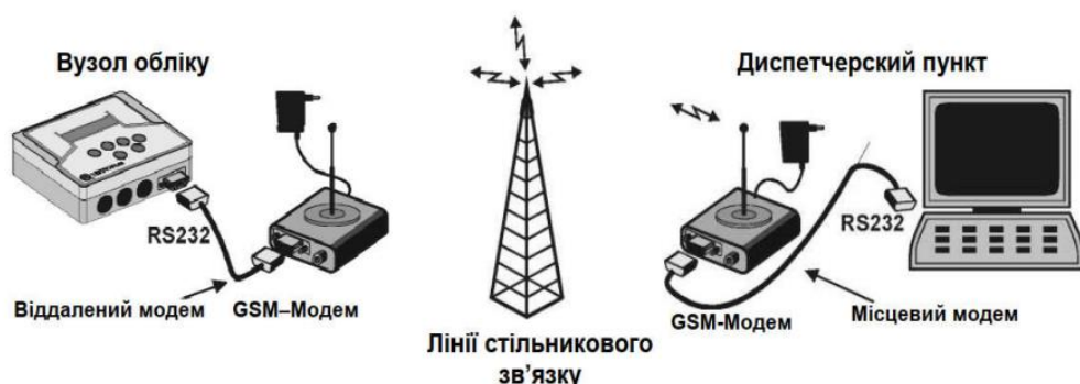
Рисунок 5.1 – Схема організації модемного зв'язку та передачі даних BOTE
