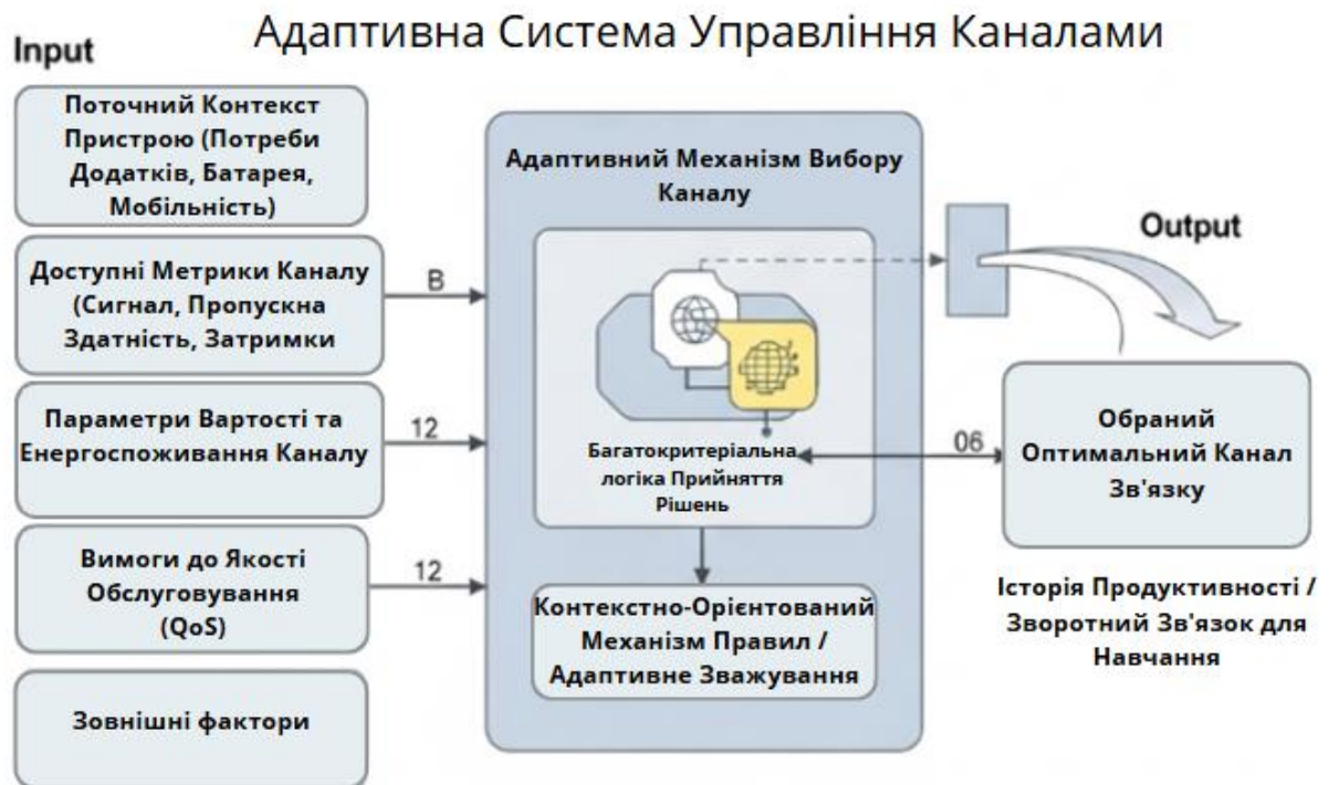
Рисунок 3.2. Концептуальна блок-схема адаптивної системи управління
