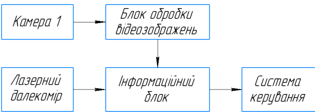
Рисунок 2.1.2. Структурна схема конфігурації з однією камерою та лазерним далекоміром
