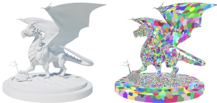
Рисунок 3.3 – Візуалізація поділу геометрії сцени на мешлети
