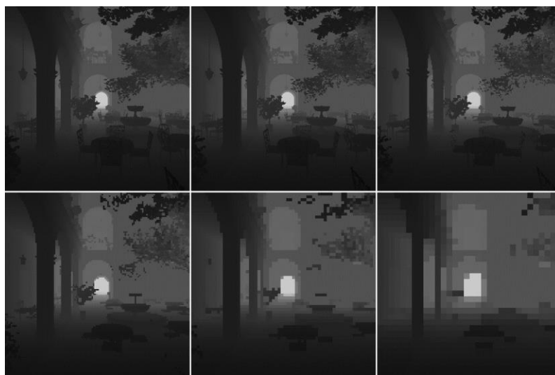
Рисунок 3.11 – Ієрархічне представлення буфера глибини
