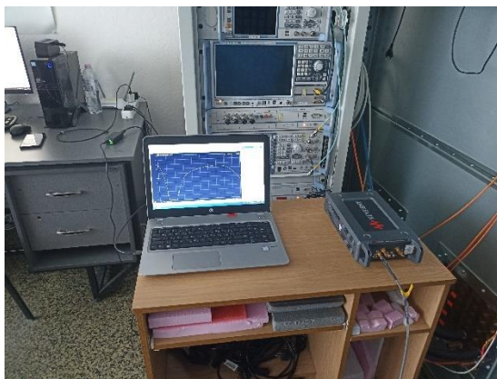
Рис. 4.10 – Фото лабораторного стенда для вимірювання параметрів антени з використанням Keysight P5020A та ECAL-модуля N443XD
