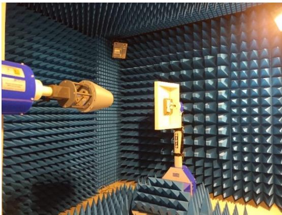
Рис. 4.13(а,б) – Видяд екранованої камери та прототип антени, встановлений у камері для вимірювання ДН
