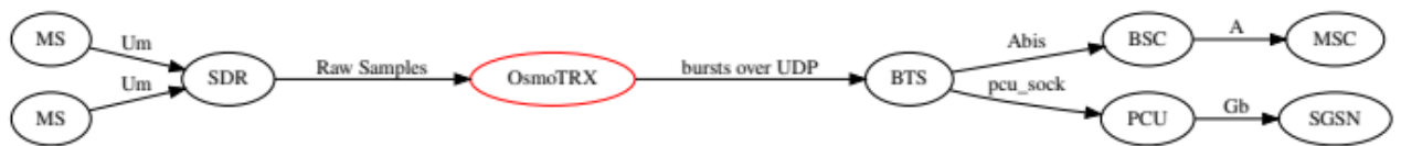
Рис. 3.2 - Деталізована блок-схема взаємодії компонентів Osmocom із LimeSDR
