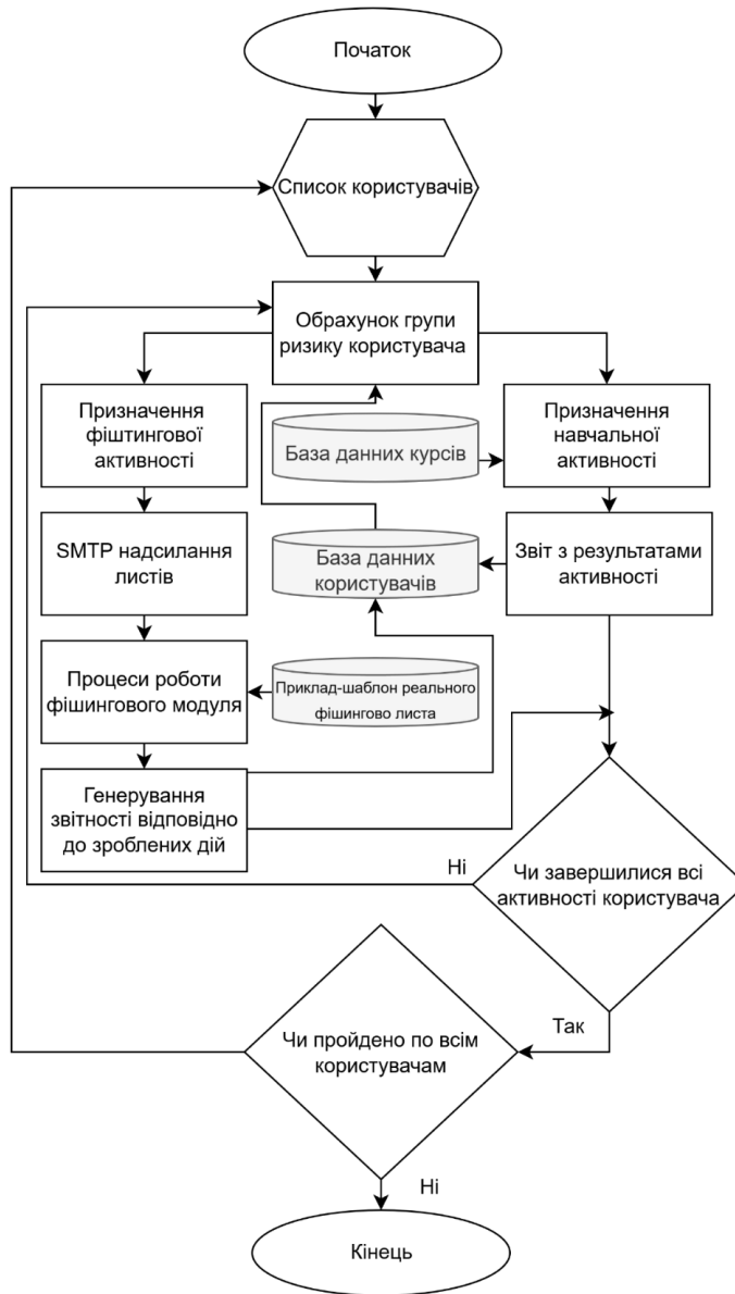
Рисунок 3.2 - Схема циклу роботи методу Simulate-Train-Measurey
