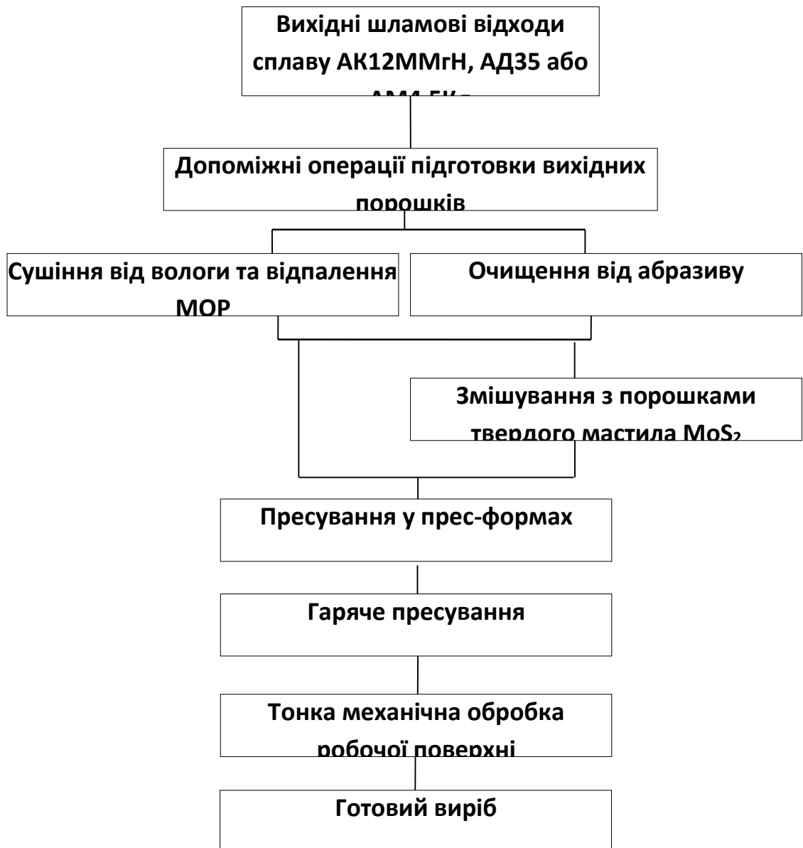
Рисунок 2.5. Технологічна схема виготовлення антифрикційних композитних деталей на основі відходів сплавів АК12ММгН, сплавів АМ4,5Кд або АД35
