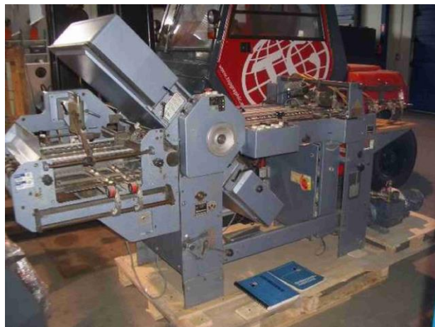
Рисунок 1.1. Загальний вигляд фальцювального апарата «Stahl FK-47 А»
