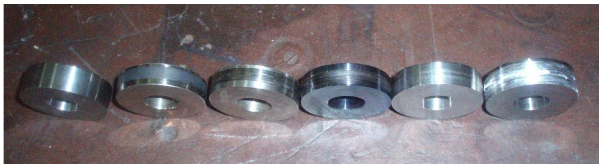
Рисунок 3.16. Загальний вигляд констрит після триботехнічних випробувань з утвореними плівками тертя
