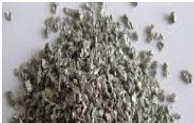
Рисунок 2.4. Загальний вигляд частинок порошків-відходів сплаву АК12ММгН після регенерації, \times 32
