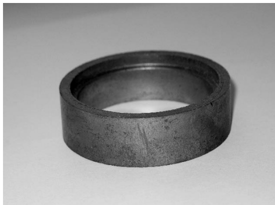
Рисунок 2.2. Заготовка втулки з композиту 2X6B8M2K7+6\%CaF_2 після спікання, укрупнення 1:2
