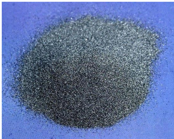
Рисунок 2.1. Загальний вигляд порошків сталі Р6М5 після очищення
