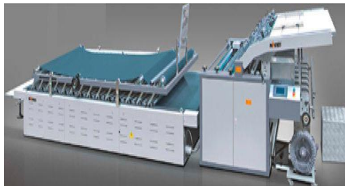
Рисунок 1.2. Загальний вигляд напівавтоматичної кашировальної машини NB 1100 B/1300B
