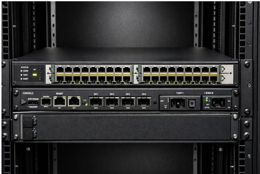
Рисунок 2.8 – DSLAM із підтримкою VDSL2 Vectoring у стійці
