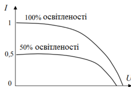
Рисунок 1.2. Вольт-амперні характеристики модуля при різній інтенсивності сонячного випромінювання.
