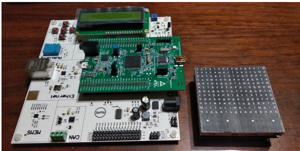
Рисунок 5.8 – Відлагоджувальна плата GL-SK та створений прототип
