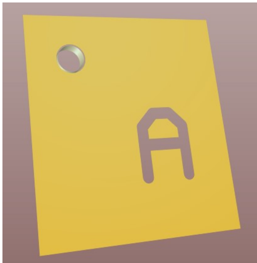
Рисунок 2.6 – Отвір в формі літери в фольгованому покритті склотекстоліту
