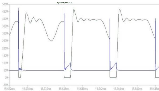
Рисунок 4. Напряга та струм стік-витік у галій-нітридовому транзисторі флябак-перетворювача
