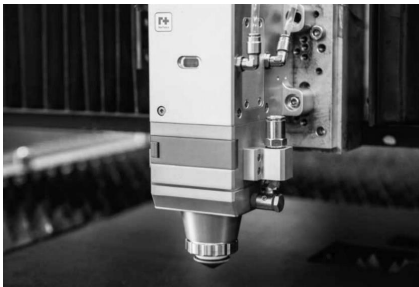
Рисунок 5.3 – Автоматична лазерна різальна головка з автофокусуванням [34]
