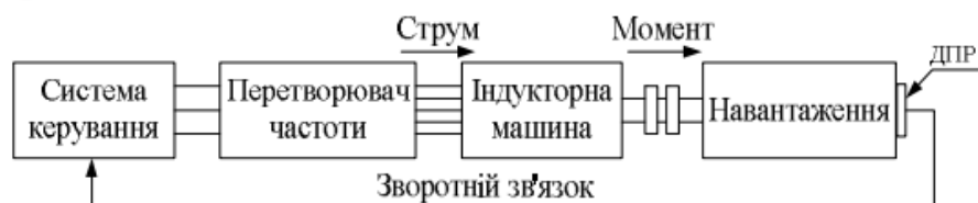
Рисунок 3.2.1 - Структурна схема ВІД.
