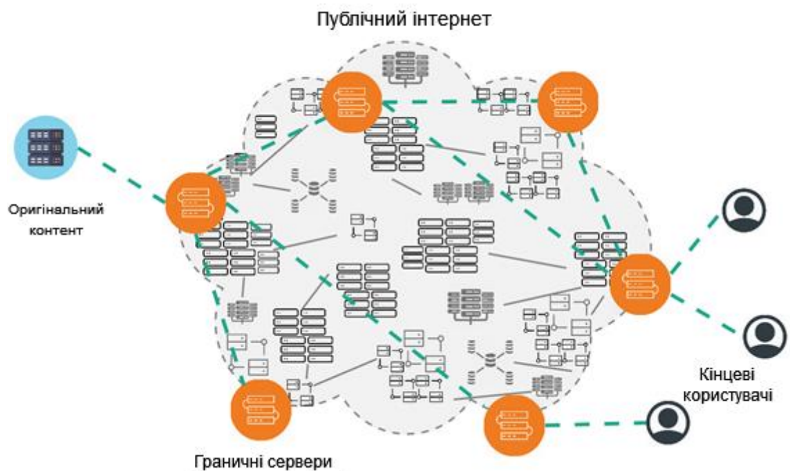
Рисунок 2.4 Візуалізація роботи серверів CDN
