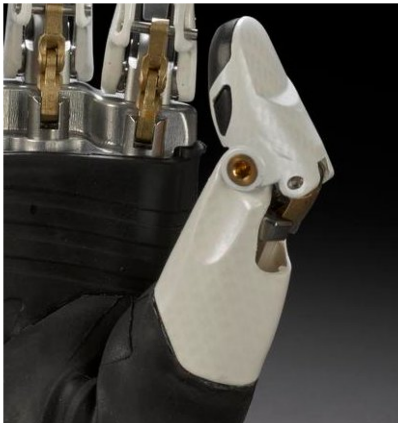
Рисунок 1.14 – Великий палець BeBionic V2 з лінійним двигуном в проксимальній фаланзі [16]
