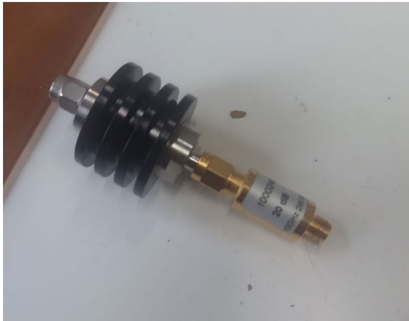
Рисунок 5.6 - два послідовних атенюатори із сумарним затуханням сигналу 50дБ
