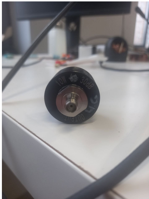
Рисунок 5.4 - Використаний атенюатор 30дБ, 10Вт
