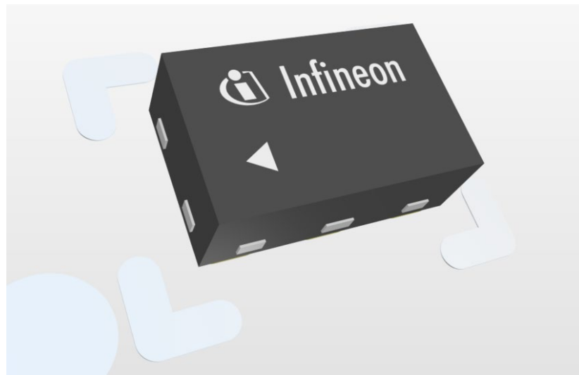
Рисунок 3.25 – Високочастотний перемикач BGS12P2L6E6327XTSA1 в середовищі Altium Designer
