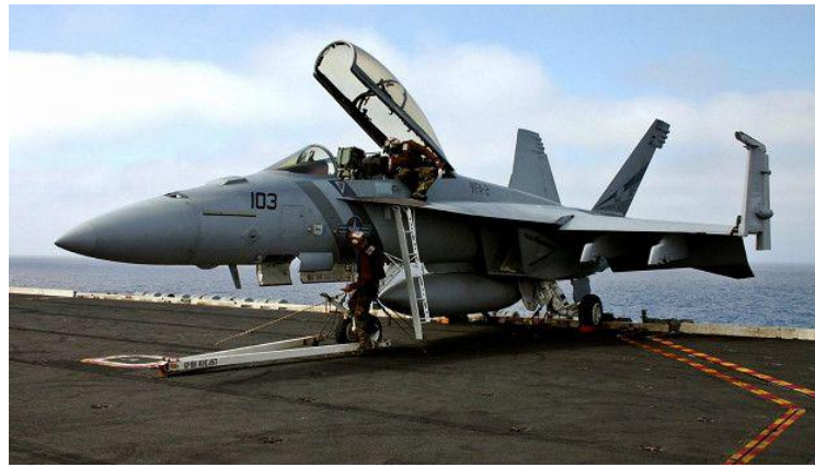
Рисунок 1.6 Крила багатьох палубних літаків складаються для економії місця на авіаносці
