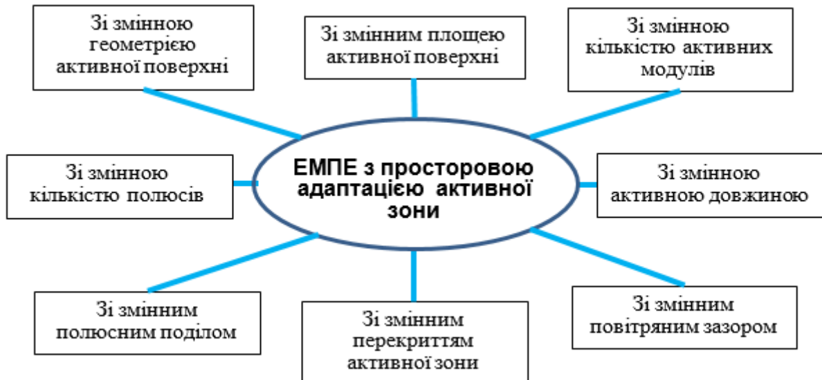
Рисунок 3.11 Класифікація способів технічної реалізації ЕМ-об'єктів з просторово адаптивною активною зоною
