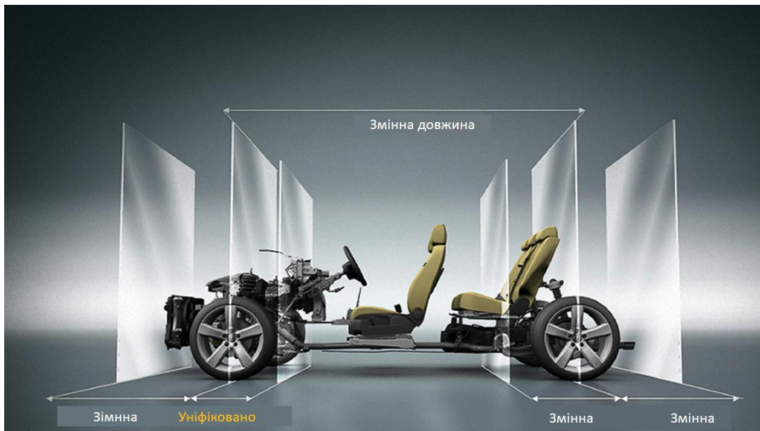
Рисунок 1.1 Швидка і зручна зміна колісної бази у модульній платформі MQB
