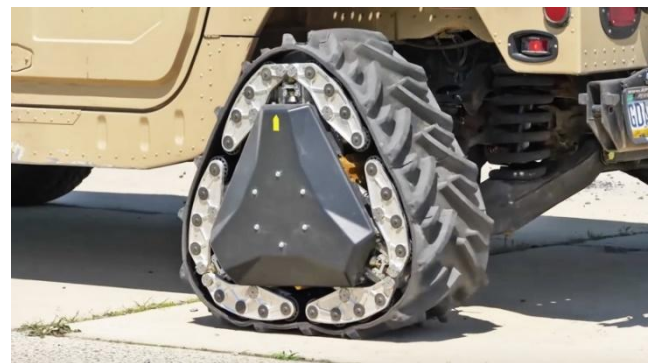
Рисунок 1.5 Гібридна система колеса RWT (Reconfigurable Wheel Track) а) кругла конфігурація колеса б) для руху по бездоріжжю гусенична к-ція
