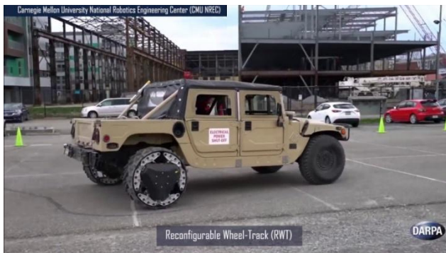
Рисунок 1.5 Гібридна система колеса RWT (Reconfigurable Wheel Track) а) кругла конфігурація колеса б) для руху по бездоріжжю гусенична к-ція
