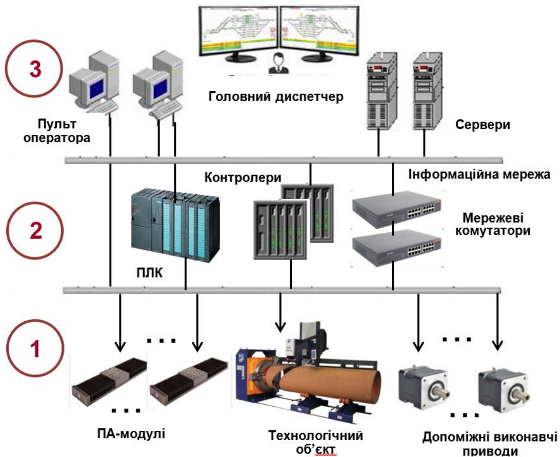
Рисунок 3.4 Узагальнена структура трирівневої системи автоматизованого керування технологічним комплексом з просторово розподіленою ЕМ-системою ПА – модулів
