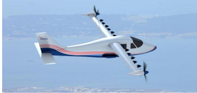
Рисунок 2.8 Ізомерна композиція поперечно-лінійного типу в модульній структурі ( k_R = 12 + 2 ) тягових електродвигунів експериментального зразка електролітака NAS-X-57 «Максвелл».
