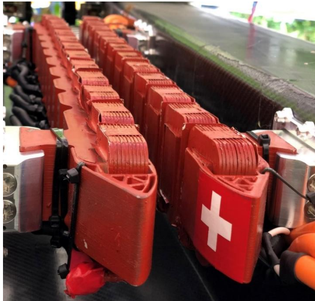
Рисунок 1.12 Модульна система ЛАД для проєкту вакуумного потягу
