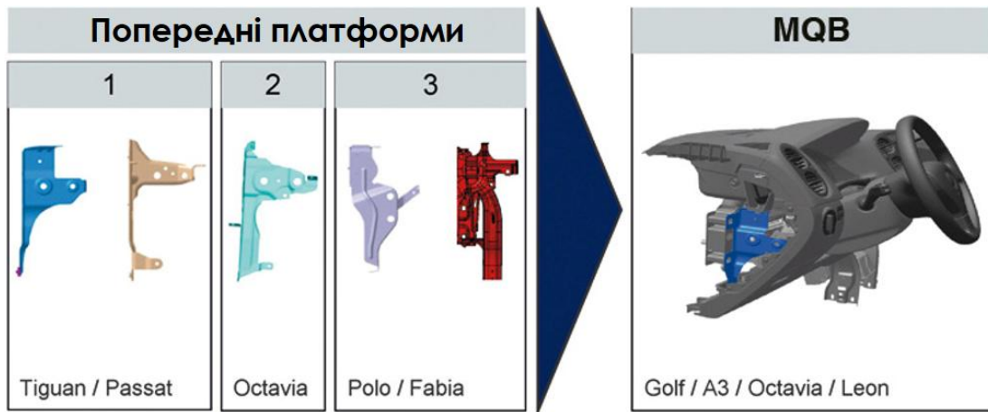
Рисунок 1.2 Уніфіковане кріплення передньої панелі на автомобілях VAG
