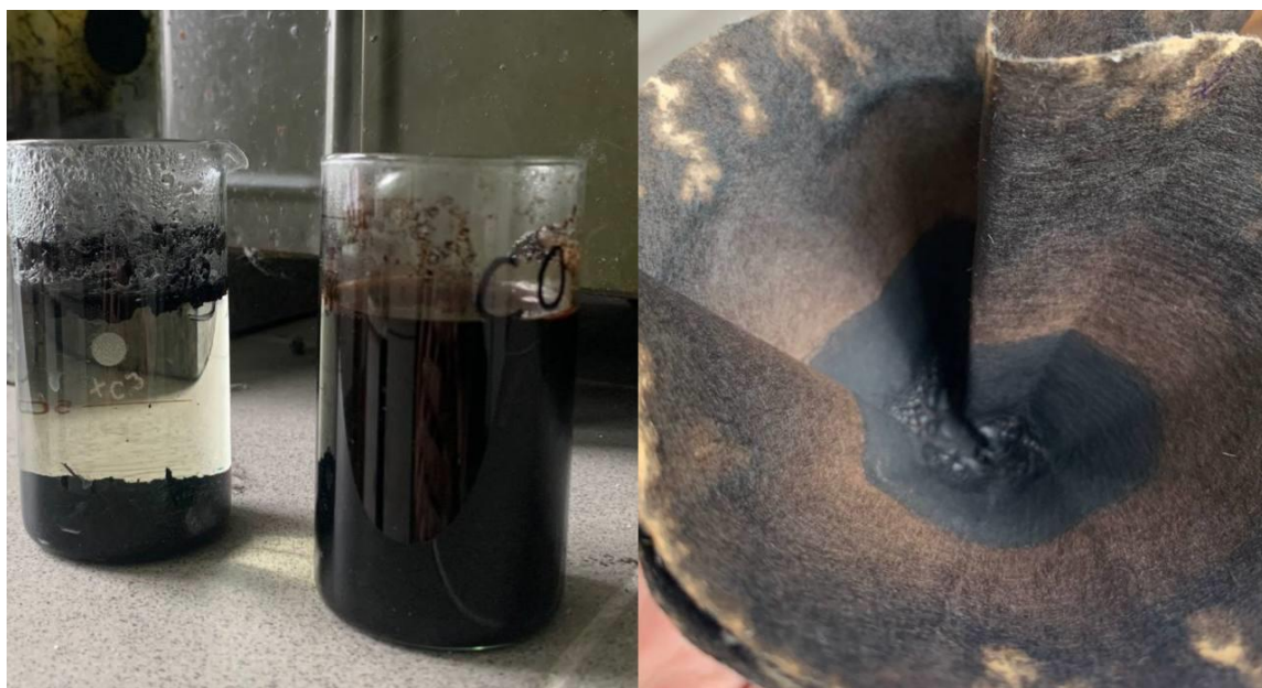
Рис 3.1 – Невдалі спроби отримати сорбент, при активації з КОН та КОН+S
