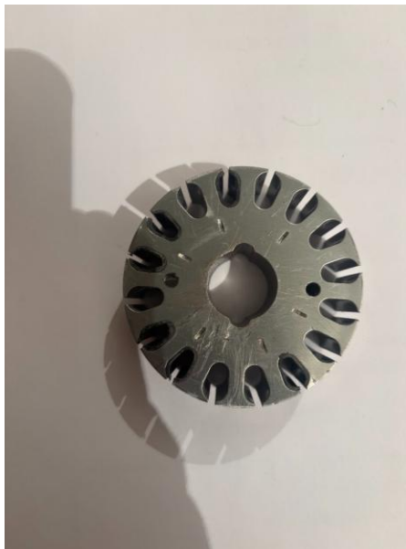
Рис. 6.1 Зовнішній вигляд статора
