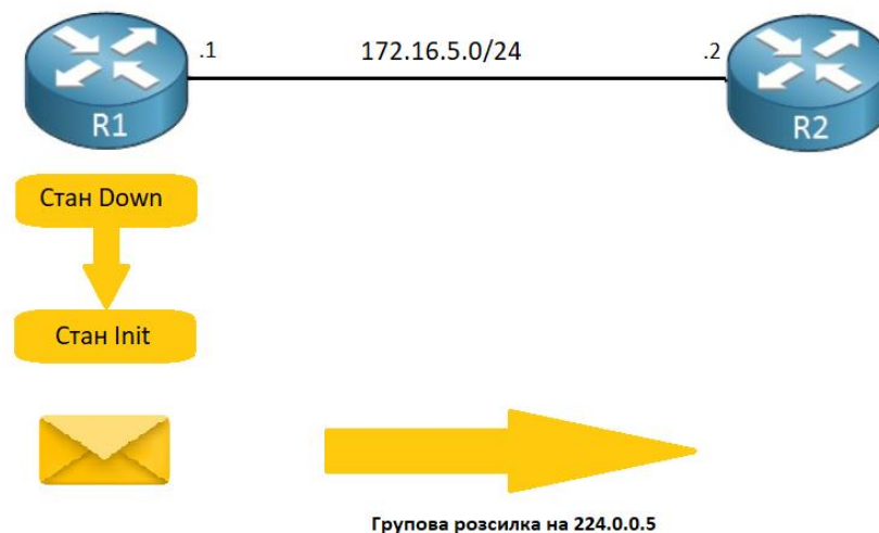
Рисунок 2.3 – Перехід зі стану Down в стан Init [3]
