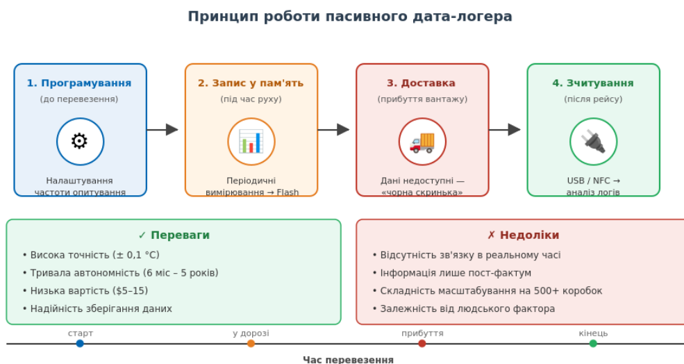
Рисунок 1.3 – Принцип роботи пасивного дата-логера
