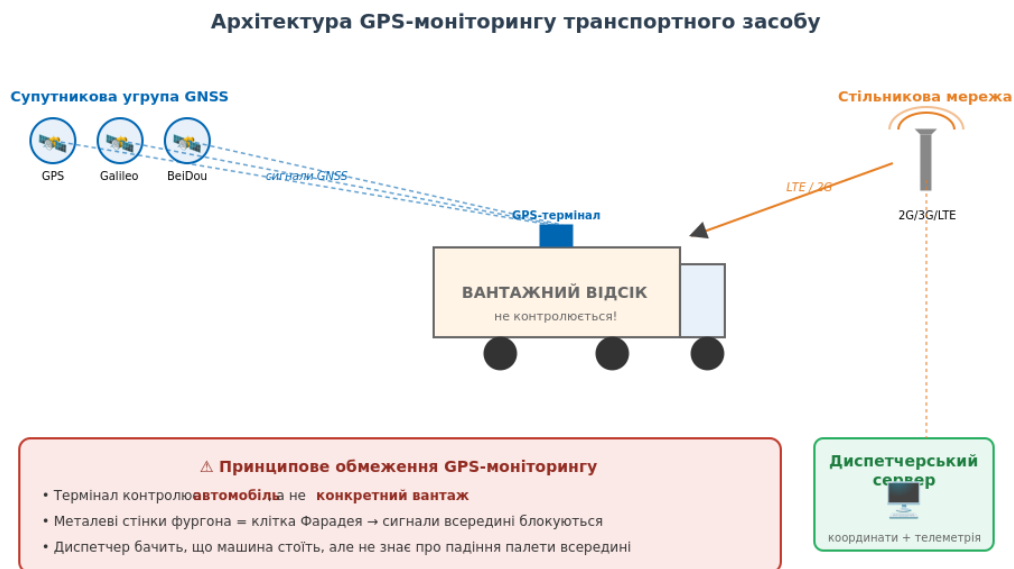
Рисунок 1.4 – Архітектура GPS-моніторингу транспортного засобу
