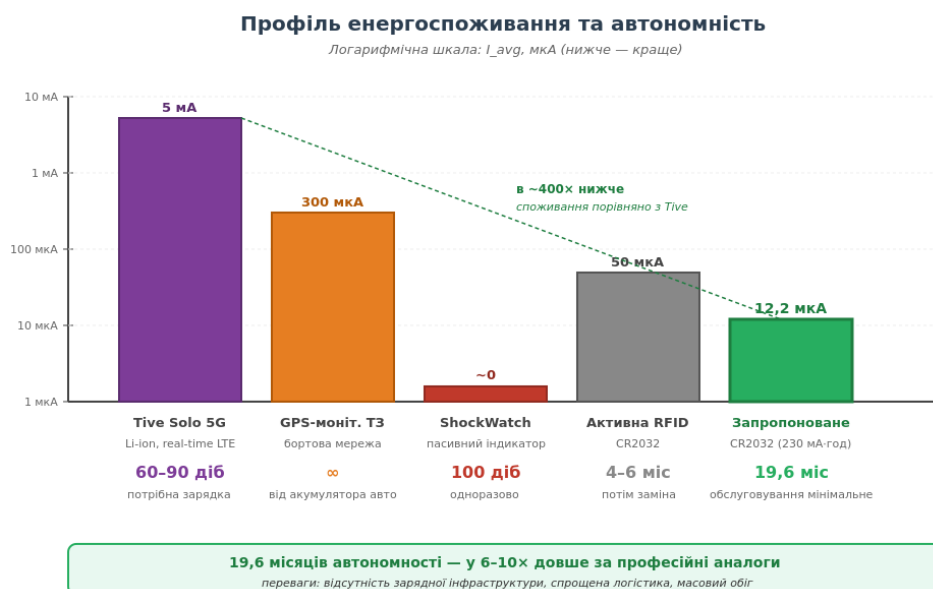
Рисунок 3.2 – Профіль енергоспоживання та автономність порівнюваних рішень
