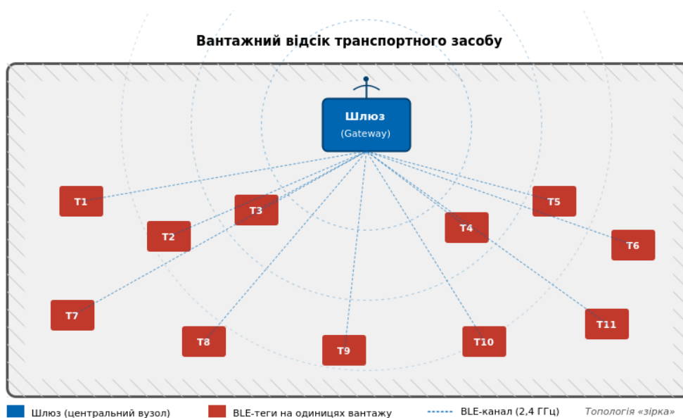
Рисунок 2.4 – Топологія «зірка» у вантажному відсіку транспортного засобу
