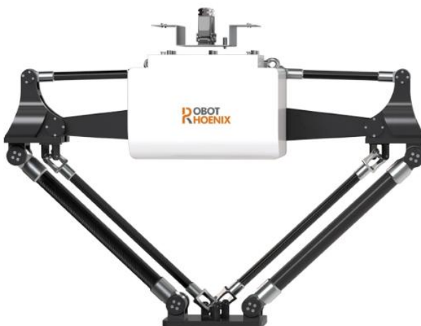
Рисунок 2.2 – Дельта-робот BAT-B1000B-S60 компанії Robotphoenix [17]
