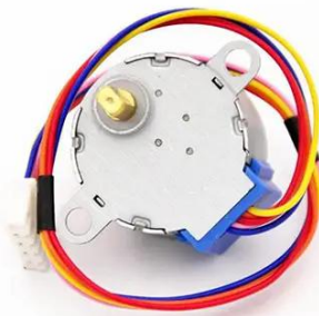
Рисунок 4.5 – Кроковий двигун 28BYJ-48 [26]
