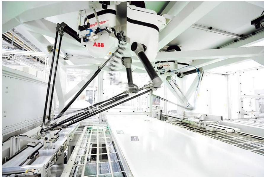
Рисунок 1.8– Дельта-робот IRB 360 FlexPicker компанії ABB на виробництві [11]
