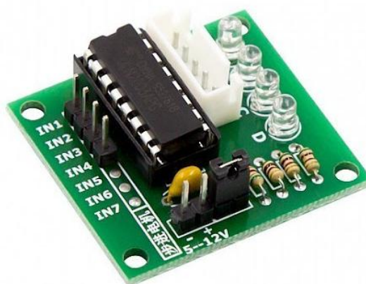
Рисунок 4.9 – Драйвер крокового двигуна ULN2003 [31]
