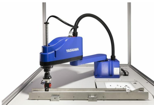
Рисунок 1.2 – SCARA-робот серії SG від компанії Yaskawa [4]
