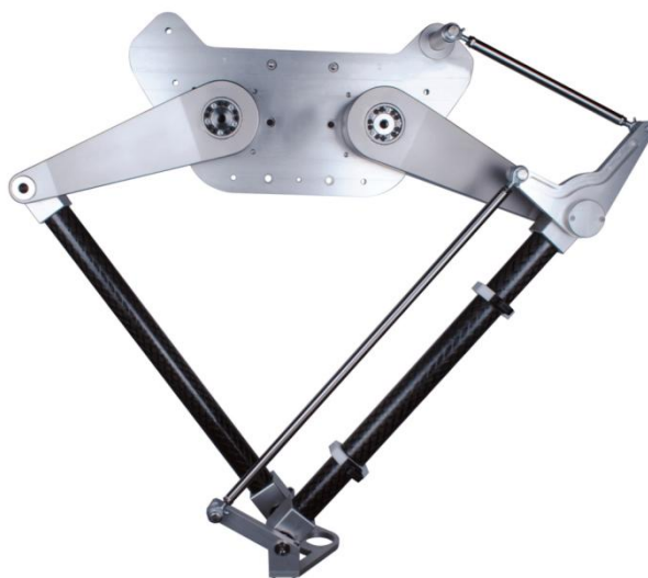
Рисунок 1.11 – 2D дельта-робот компанії OMRON [12]
