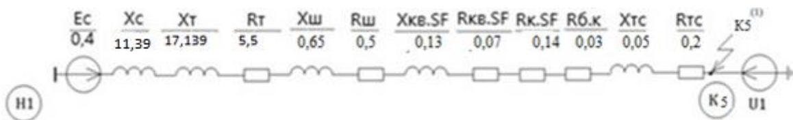
Рисунок 2.11 Схема заміщення прямої послідовності
