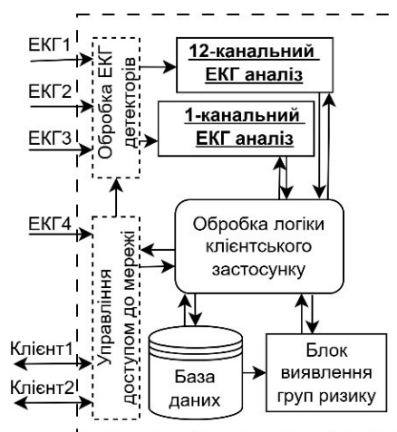
Рис. 6.2. Блок-схема системи автоматизованого виявлення аритмій за допомогою методів машинного навчання
