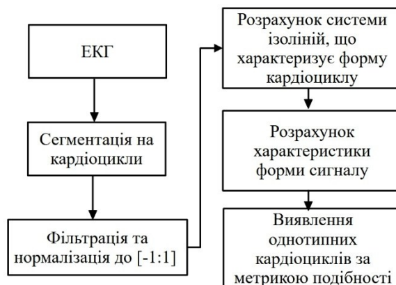
Рис. 4.3. Блок-схема алгоритму виявлення нетипових форм QRS комплексів
