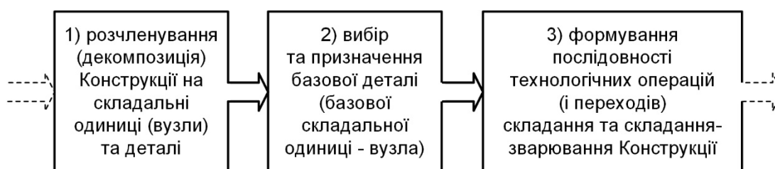
Рис. 5.1. Алгоритм призначення технологічної послідовності складання-зварювання Конструкції
