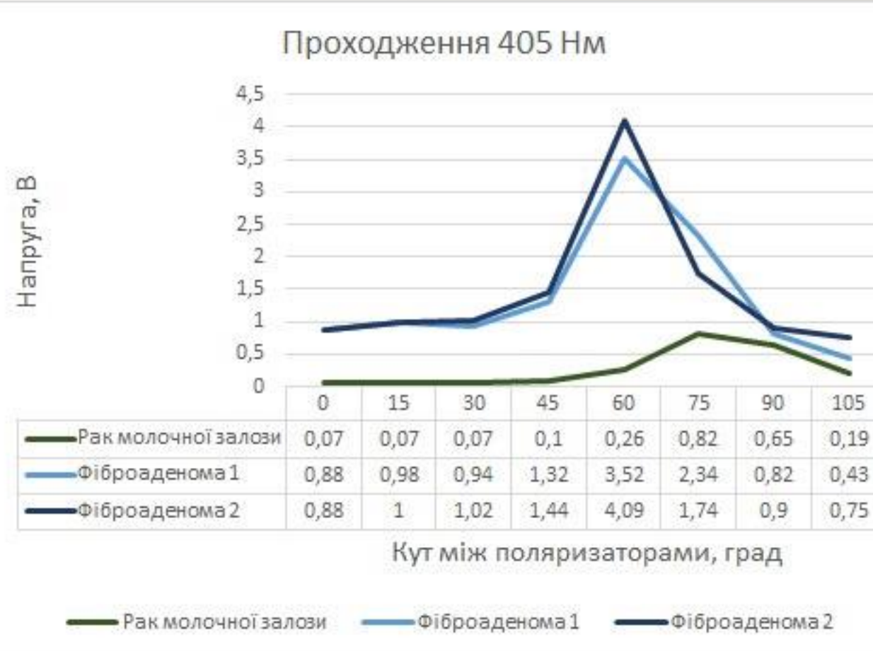
Рис.27. Залежність значень напруги від кута між поляризаторами для гістологічних зрізів тканин молочної залози при проходженні випромінювання довжини хвилі 405 нм
