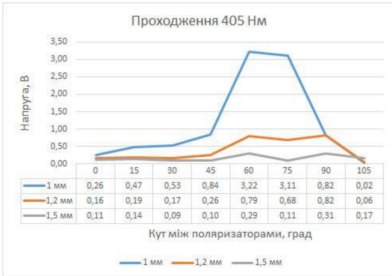
Рис.3.6. Залежність значень напруги від кута між поляризаторами для грудних м'язів курки різної товщини при проходженні випромінювання довжини хвилі 405 нм
