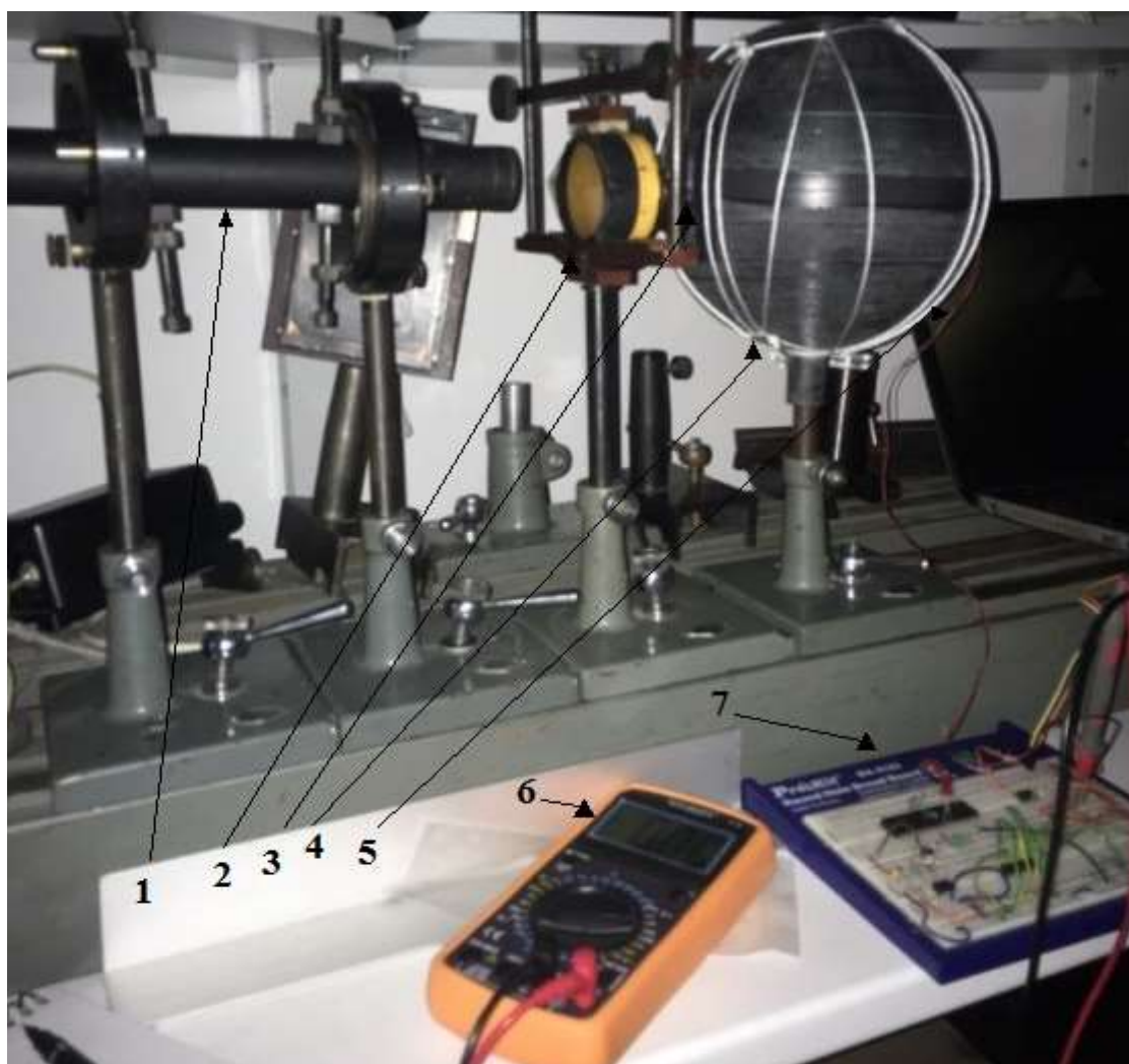
Рис.3.1 Макет спектрофотометру: 1- джерело світла (лазер), 2- система поляризаторів, 3- паз для встановлення зразка 4-інтегруюча сфера, 5-шнур фотодіода, 6- вольтметр, 7- схема для визначення освітленості сфери
