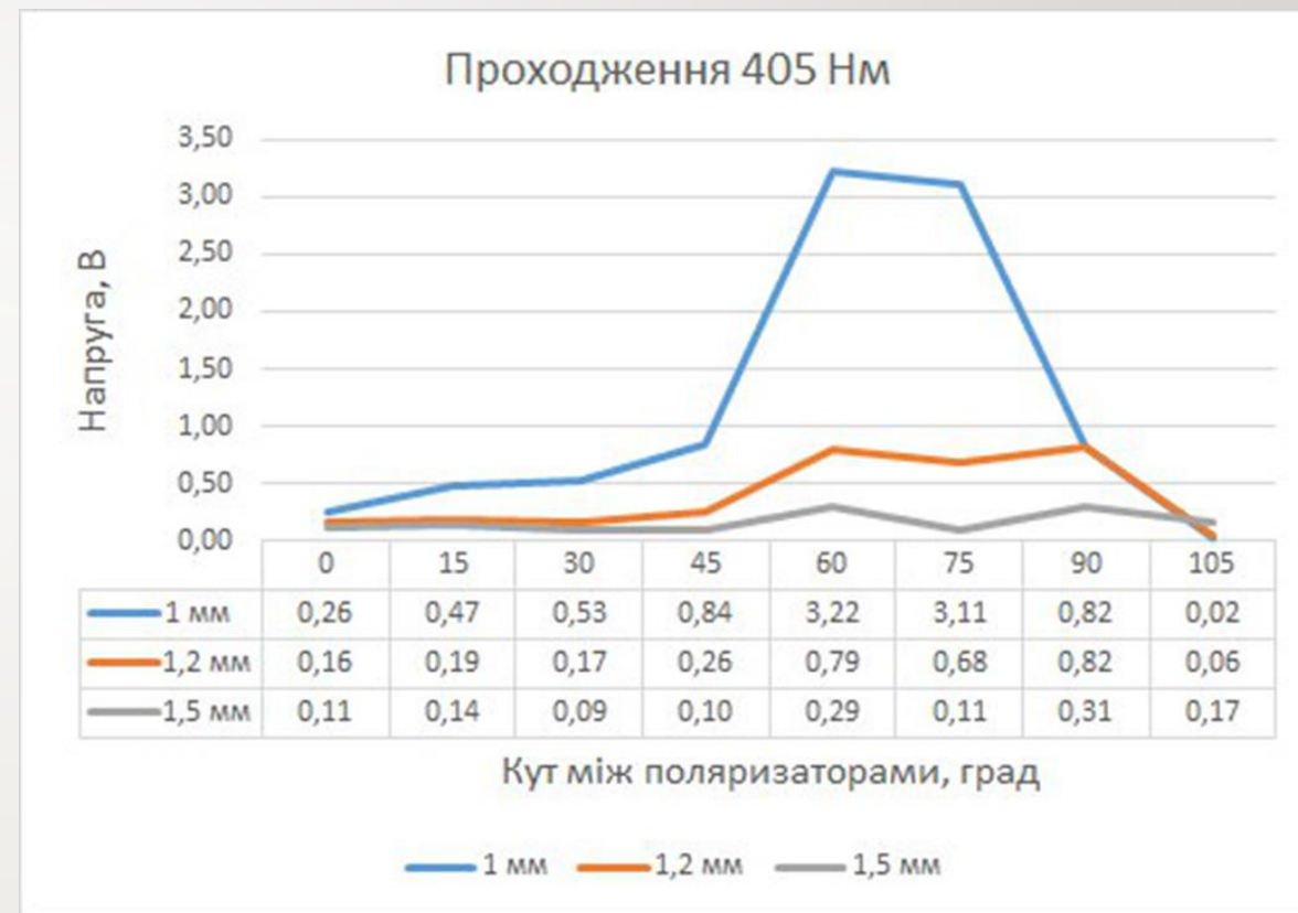
Рис.29. Залежність значень напруги від кута між поляризаторами для грудних м'язів курки різної товщини при проходженні випромінювання довжини хвилі 405 нм
