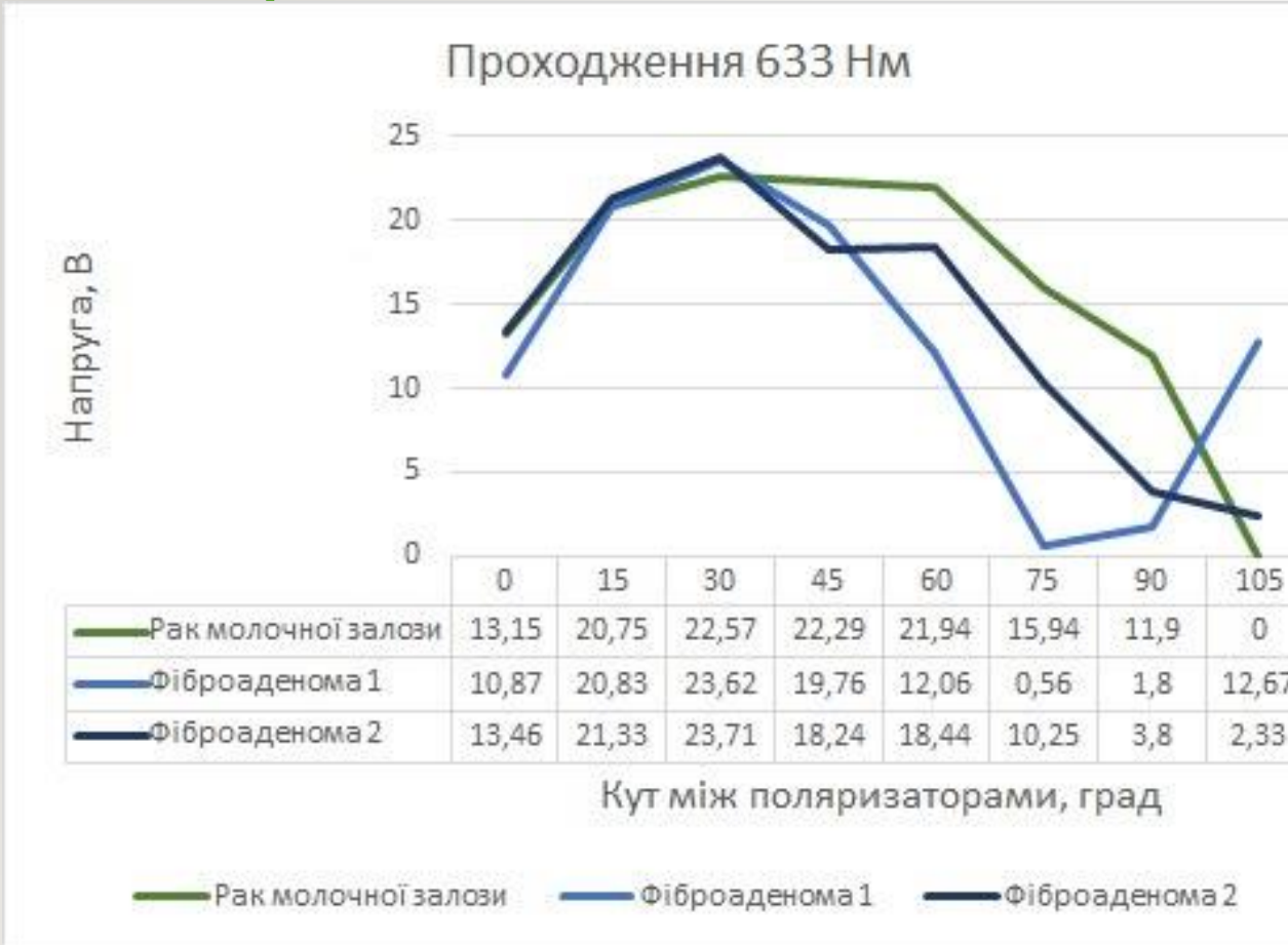
Рис.26. Залежність значень напруги від кута між поляризаторами для гістологічних зрізів тканин молочної залози при проходженні випромінювання довжини хвилі 633 нм
