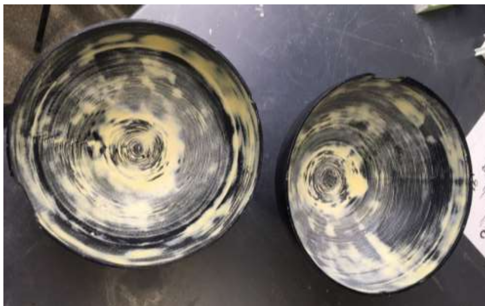
Рис.2.15 Підготовлені напів сфери для нанесення покриття
