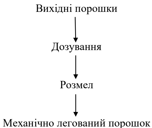
Рисунок 2.1 – Технологічна схема одержання ВЕС методом МЛ
