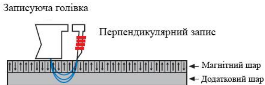
Рисунок 1.3 – Схема перпендикулярного запису інформації на магнітні накопичувачі [10]
