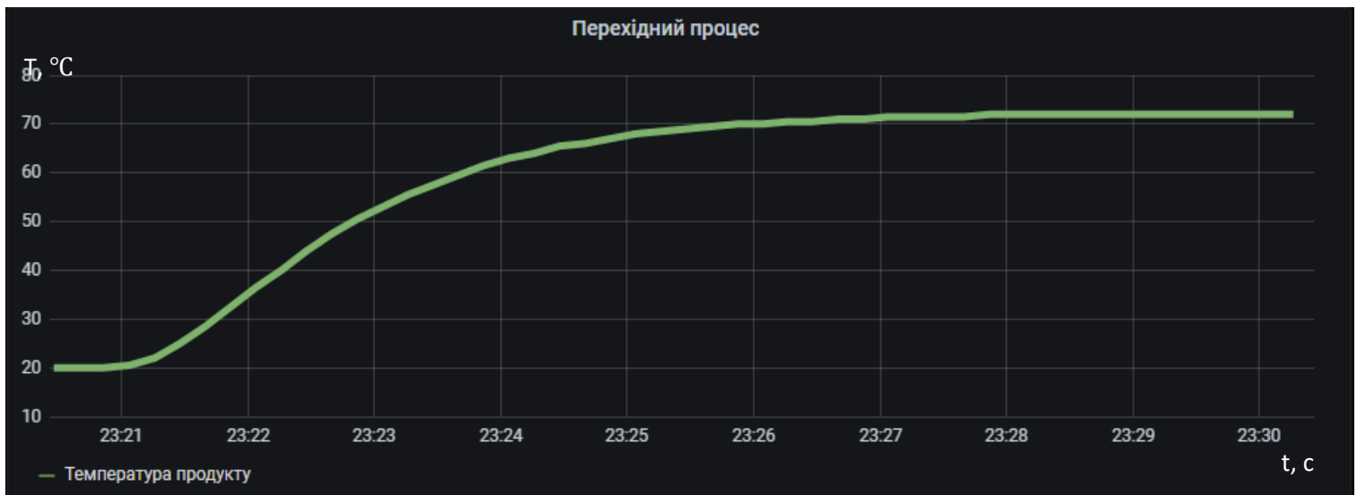
Рис 3.36 Перехідний процес температури продукту в середовищі Grafana
