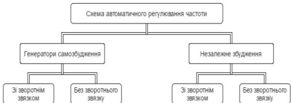
Рис. 10 Способи автоматичного регулювання частоти
