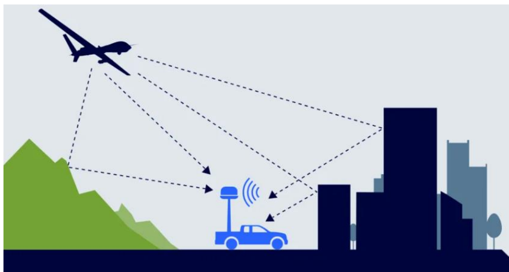
Рисунок 1.1 – Вплив радіочастотної багатопроменевої системи на пеленгацію та геолокацію
