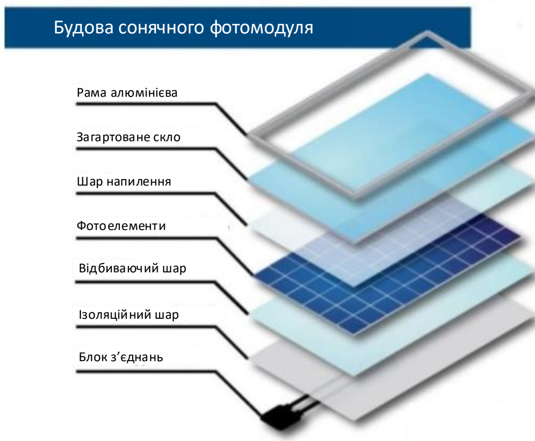
Рисунок 1.2.6 — Будова полікристалічної сонячної панелі.
