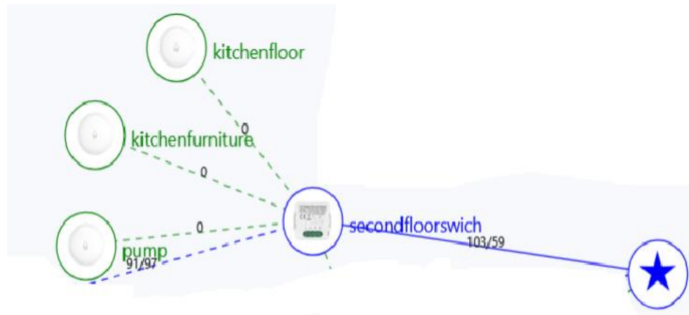
Рисунок 3.6 - Mesh-топологія цього проекту
