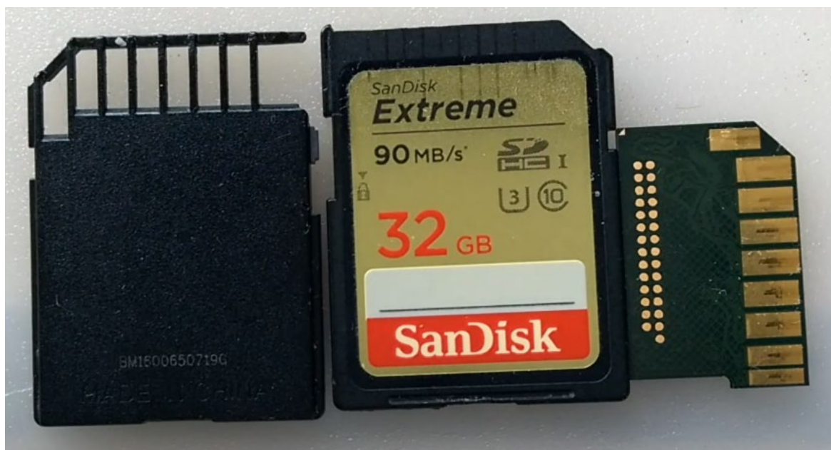
Рисунок 2 – Зовнішній вигляд розібраної на частини SDHC
