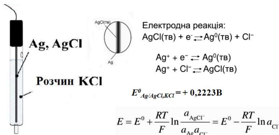
Рис.5.5. Будова хлорсрібного електроду
